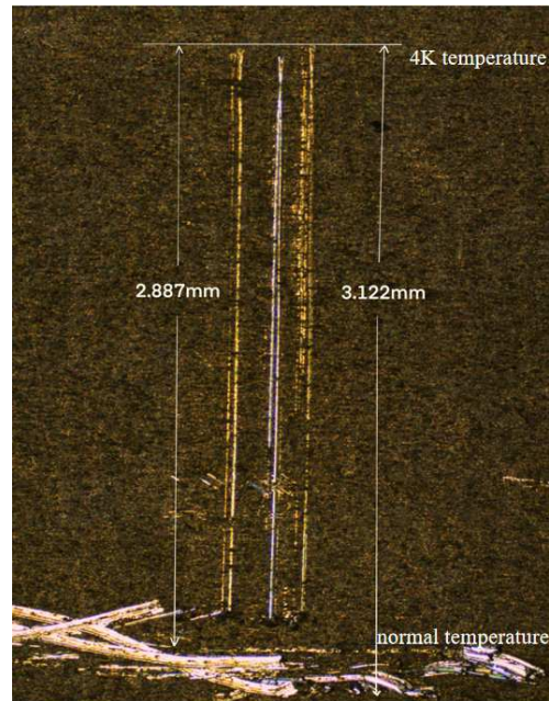
图10 在测量显微镜下测量的划痕
