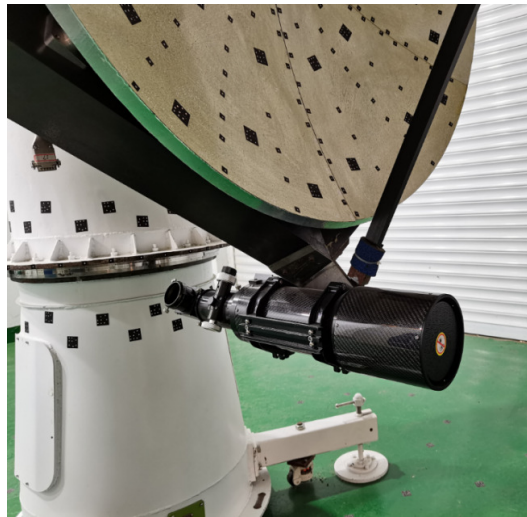
图2 安装在太赫兹天线上的光学望远镜
