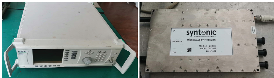
图 5 左图是型号MG3692B信号发生器, 右图是型号DS-3002信号发生器.
